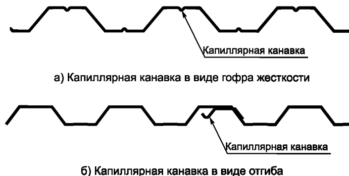
Рисунок 3 — Основные виды капиллярных канавок
